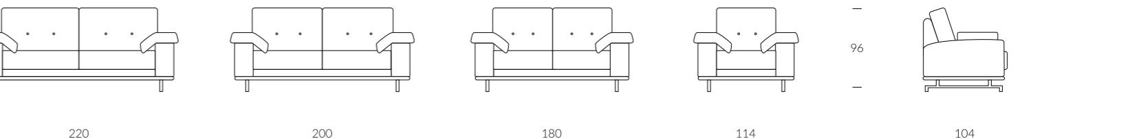
Modello completamente sfoderabile, fusto in legno di abete e multistrato di pioppo. Imbottitura in poliuretano espanso indeformabile a quote differenti. Cuscini di seduta a molle con tipologia Soft System. La base e i piedi in acciaio spazzolato sono di serie. Invece, per finiture diverse, considerare la maggiorazione come da listino.
