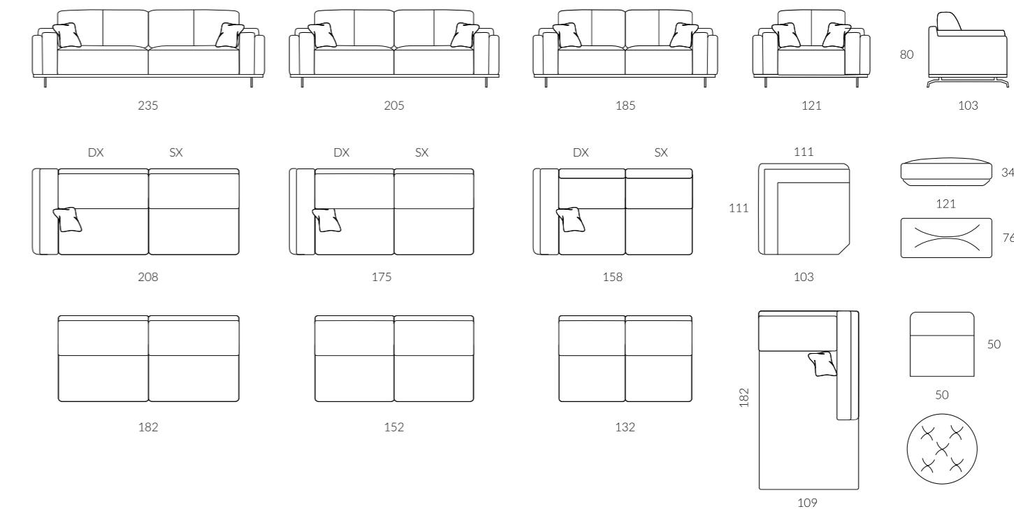
Divano parzialmente sfoderabile nella versione in tessuto. Struttura in legno di abete e multistrato di pioppo. Imbottitura in poliuretano espanso indeformabile a quote differenziate. Cuscini di seduta a molle con tipologia SOFT-SYSTEM. Le slitte sono in acciaio di serie. Per finiture particolari considerare la maggiorazione come da listino.
