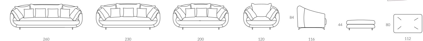
Divano completamente sfoderabile. Struttura in legno di abete e multistrato di pioppo. Imbottitura in poliuretano espanso indeformabile a quote differenziate. Gli schienali in piuma e i cuscini laterali in piuma sono di serie. Cuscino di seduta a molle con SOFT-SYSTEM. Le slitte sono in acciaio di serie. Per finiture particolari considerare la maggiorazione come da listino.
