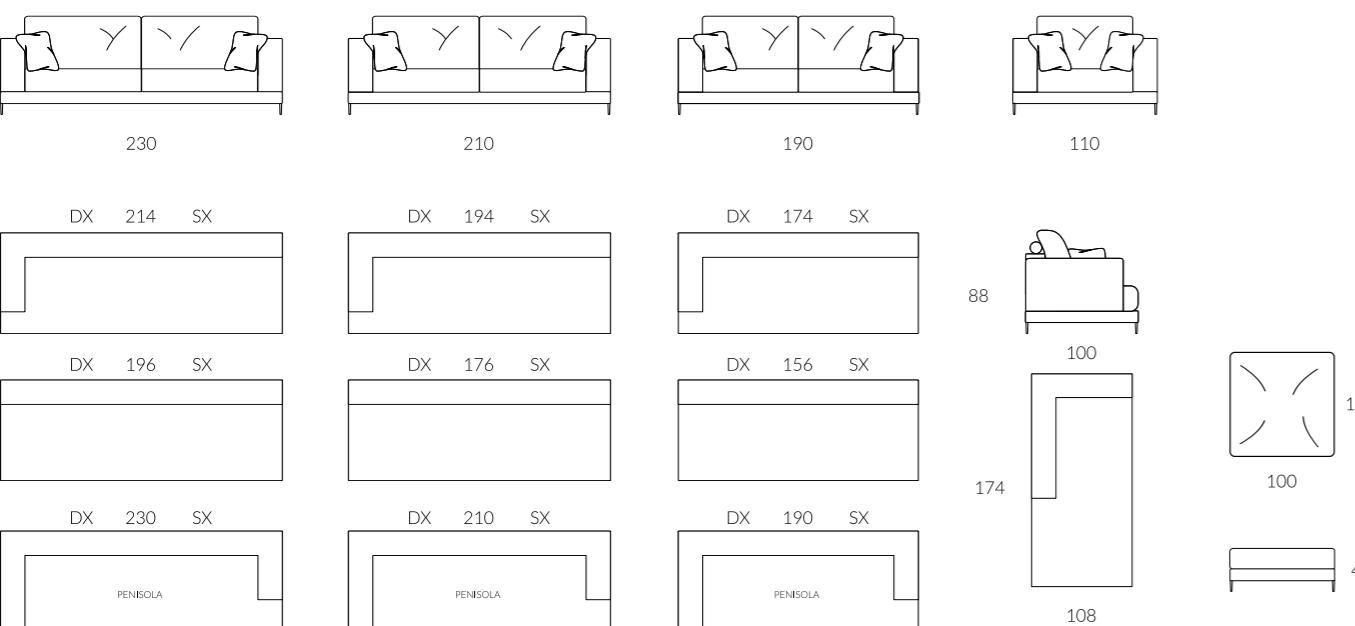
Divano completamente sfoderabile nella versione in tessuto. Struttura in legno di abete e multistrato di pioppo. Imbottitura in poliuretano espanso indeformabile a quote differenziate. Cuscini di seduta a molle con SOFT-SYSTEM. Schienali e cuscini laterali imbottiti in piuma d'oca. Piedi in acciaio di serie. Per finiture particolari considerare la maggiorazione come da listino.
