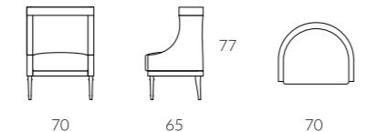
Struttura in legno di faggio con possibilità di allestire il retro e interno schiena con paglia di Vienna. La sedia è in poliuretano espanso a quote differenziate con tecnologia SOFT-SYSTEM.
